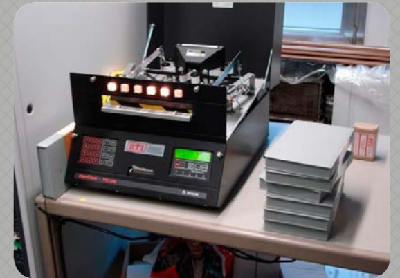
Een TapeCheck Pro Line apparaat (RTI) met ¾" U-matic tapes bij de VRT. Foto: PACKED vzw.
