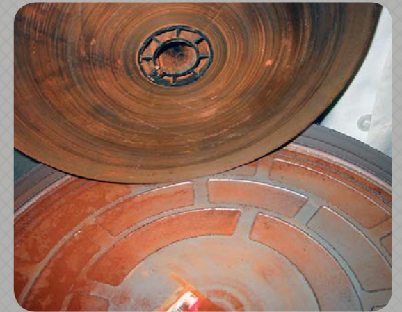
Gezuiverde ijzeroxide, gebruikt als coating voor magnetische opslagmedia, is door verval losgekomen van de drager en herkenbaar als roestkleurig poeder. © DeLuxe Entertainment Services Group Inc.
