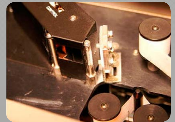
Detailopname van het rolletje reinigungs papier en de schraapmesses in een RTI-reinigungsstoestel. Foto: clubic.com.
