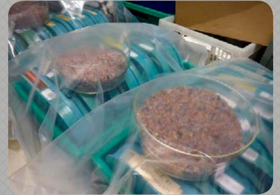
Het gebruik van silicagel bij het drogen van 1" videotapes. Foto PACKED vzw.
