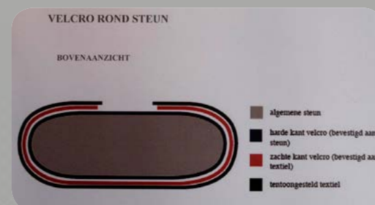
Vlak textiel voorzien van voering en velcro – vastgemaakt aan velcro rond steunvorm © Griet Kockelkoren.
