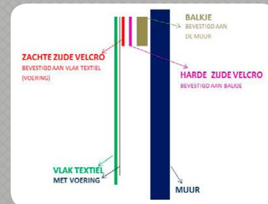
Technische tekening ophangstelsel vlak textiel © Griet Kockelkoren. Een wandtapijt ophangen is niet zo evident: http://britishlibrary.typepad.co.uk/collectioncare/2014/03/cleaning-and-rehanging-the-kitaj-tapestry.html en www.metmuseum.org/exhibitions/listings/2014/grand-design/blog/posts/hanging-the-tapestries .
