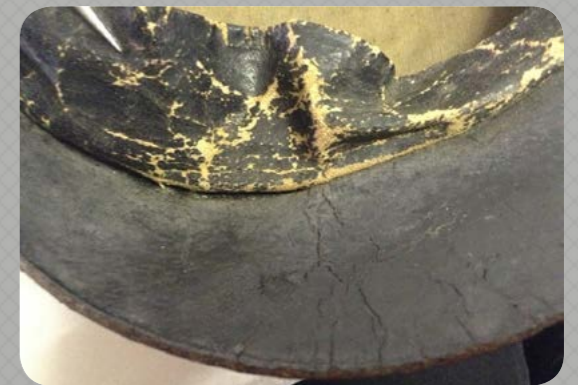
Binnenzijde hoofddeksel: coating op textiel is helemaal gecracqueleerd (combinatie van factoren) © Griet Kockelkoren.
